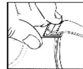
Forma de ajuste de horquilla de bandas o correas. Para su fijación, encaje los agujeros en la hebilla.
